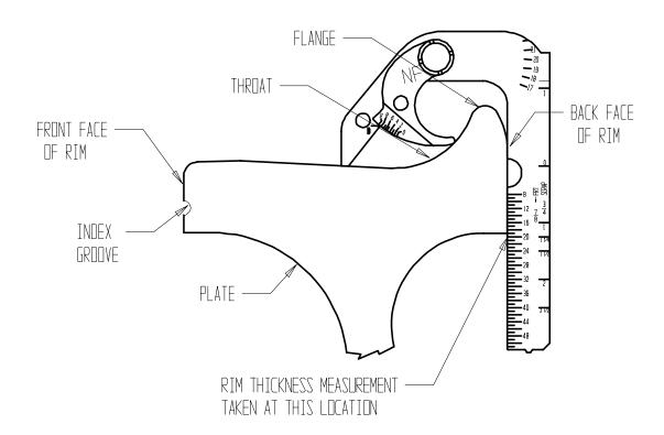
PLACE WHEEL GAGE ON BACK FACE OF RIM WITH HOOK ON THE TREAD OF THE WHEEL. ENSURE THAT GAGE IS FLUSH WITH THE BACK FACE OF THE RIM AND THE HOOK IS IN CONTACT WITH THE TREAD OF THE WHEEL. TAKE READING ON THE WHEEL GAGE AT THE RULER SCALE AND THE EDGE AT THE BOTTOM OF THE BACK FACE OF THE WHEEL.
